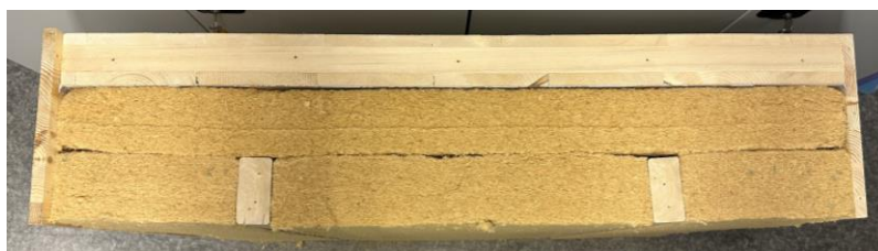
Fig. 4.15: Trefiberløsning sett ovenfra
