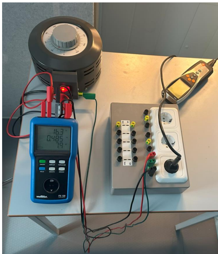
Fig. 4.28: Strømforsyning og tilhørende utstyr
