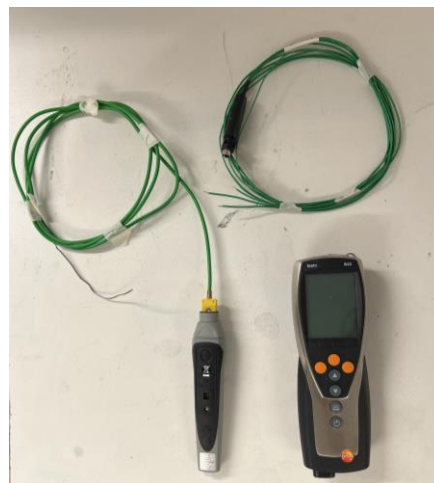
Fig. 4.32: U-verdimåler og temperatursensor med radiosender
